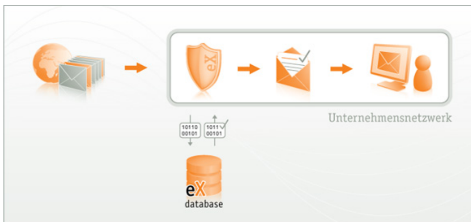
Abbildung 1.1.: eXpurgate als Inhouse-Installation. Die Verarbeitung der E-Mails erfolgt im Unternehmensnetzwerk. Es werden nur Kontrollsummen mit der eXpurgate Datenbank ausgetauscht.
